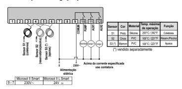
Nota: O comprimento do cabo do sensor pode ser aumentado pelo próprio usuário, em até 200 metros, utilizando cabo 2 x 24 AWG.
